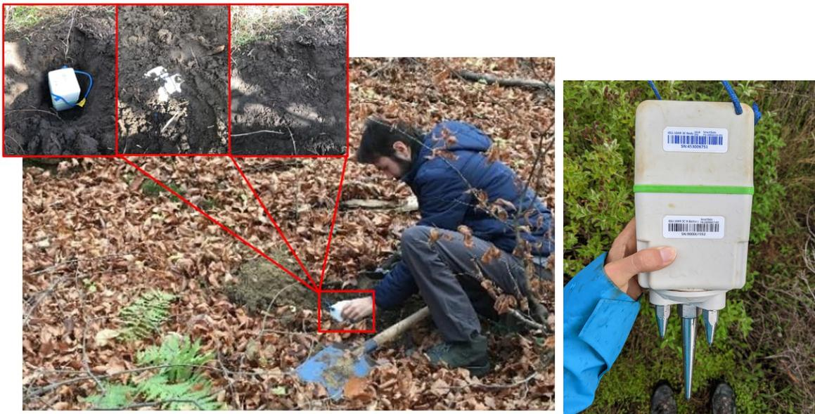
Abbildung 2: Ausbringung eines seismischen Knotensensors (Geophon). Die eingerahmten Bilder zeigen, dass der Sensor vollständig unter etwa 10 cm Erdoberfläche vergraben ist. So ist er im Grund genommen nicht sichtbar, und dürfte somit auch nicht als Belastung empfunden werden.
